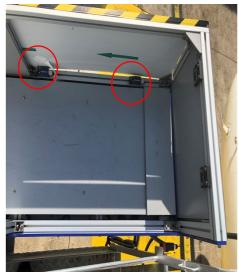
Il terzo finecorsa è posizionato come indicato nelle immagini seguenti, e consente di BLOCCARE la slitta nel caso in cui gli oggetti trasportati tocchino la parete verticale interna della macchina prima che la slitta vada in battuta sul limite di corsa.
