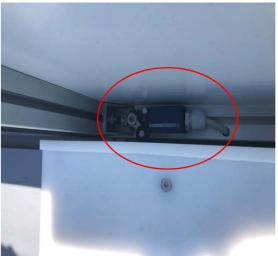
Nell'area di carico inferiore, ai fini di sicurezza, è posizionata una barriera fotoelettrica che ARRESTA la movimentazione della macchina in qualsiasi posizione della slitta nel caso in cui un conduttore o manutentore provano accidentalmente a inserire le mani nella zona protetta.
